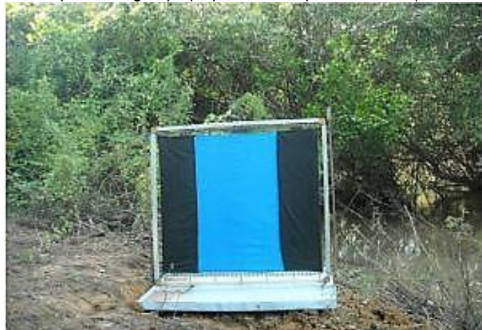
Figure 1 : Ecran noir/bleu/noir standard (1m x1m NBN) inséré dans une grille électrique, posé sur la rive du fleuve Mouhoun.
