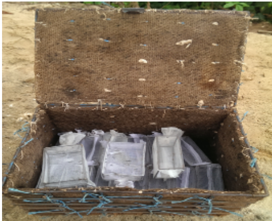
Figure 2 : Container humidifié utilisé pour le transport des cages contenant les glossines. Il produit des conditions climatiques optimales pour assurer le transfert des tsé-tsé du terrain vers le laboratoire ou le lieu de stockage temporaire.
